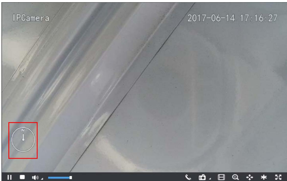
Рисунок 4-17 Отображение азимута в режиме реального времени
