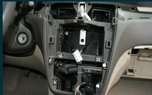
Снятие и доработка центральной консоли
